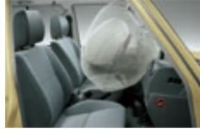
أكياس هواء SRS\* المزدوجة للمقاعد الأمامية تكمل فعل تقييد الحركة الذي تؤديه أحزمة المقاعد لتوفير المزيد من الحماية في حالة التصادم من الأمام. (اختياري) \*نظام تقييد الحركة التكميلي
